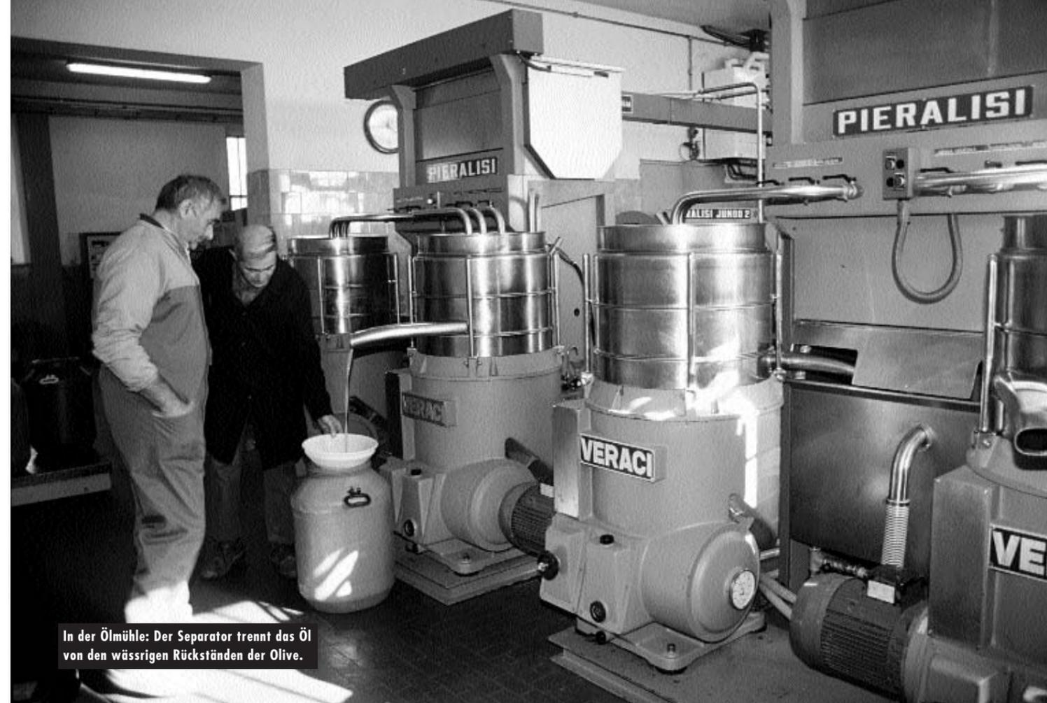
In der Ölmühle: Der Separator trennt das Öl von den wässrigen Rückständen der Olive.
